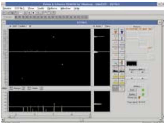
Модуль RAMON Monitor осуществляет наблюдение за представляющими интерес сигналами. Модуль можно сконфигурировать для работы с различными приемниками, что позволяет полностью перекрыть частотные диапазоны от ВЧ до СВЧ.
